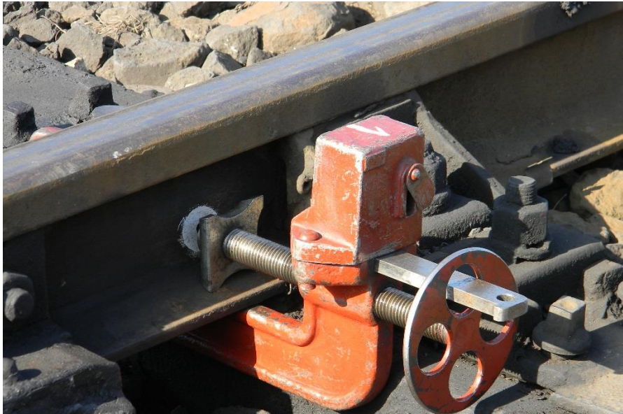
Rys. 1 Miejsce mocowania ostrza śrubowego sworznia spony
